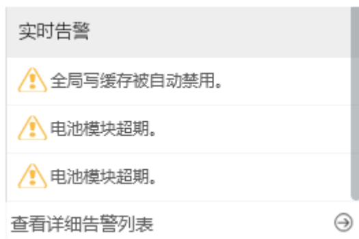
图3-7 ODSP Scope+告警项示例
